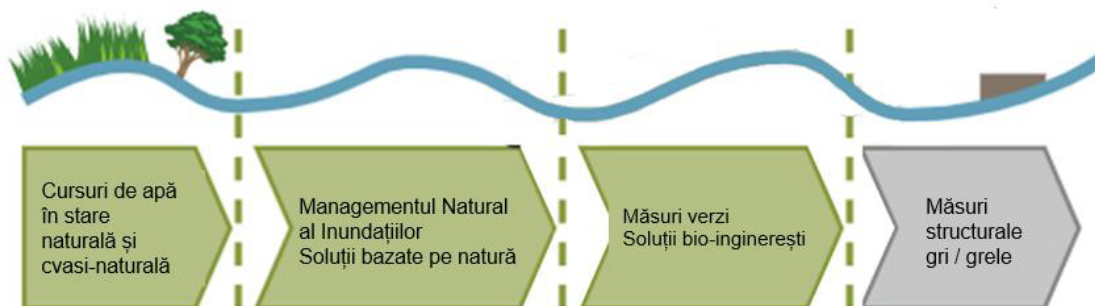
Figura 6 - Integrarea secvențială a Managementului Natural al Inundațiilor și a Soluțiilor Verzi / bio-inginerești în Managementul Riscului la Inundații
